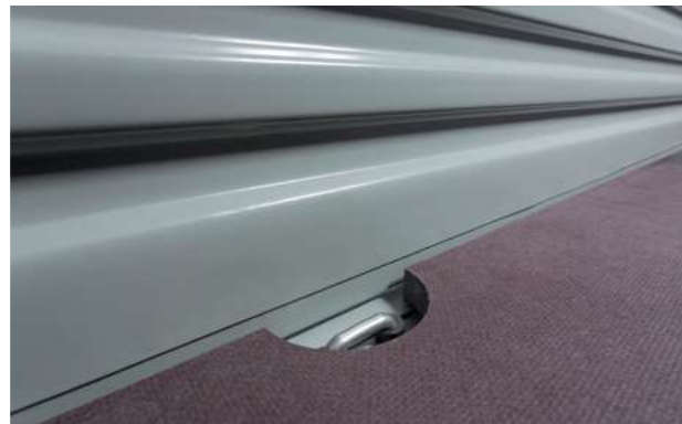
Пол с транспортной фанерой, а крепление груза возможно скрытыми такелажными петлями
