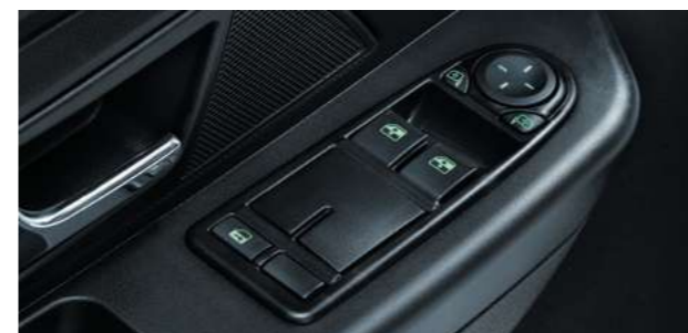
Управление электростеклоподъемниками и внешними зеркалами на водительской двери
