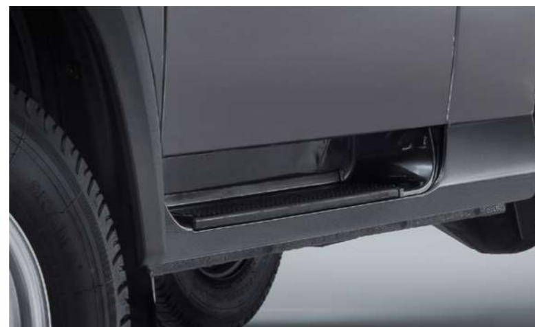
Подножки с противоскользящим покрытием
