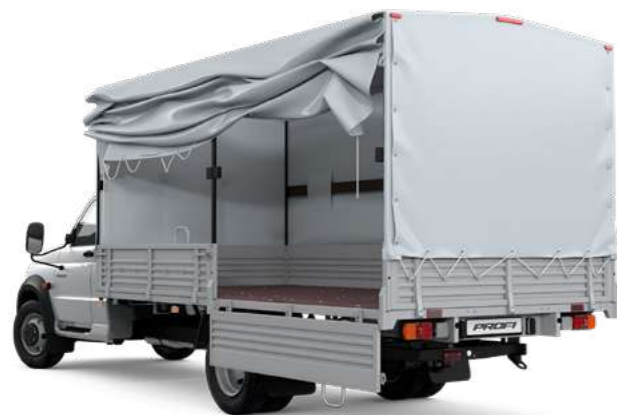
Платформа с возможностью отдельного открывания бортов
